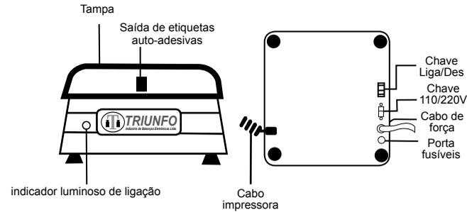
3.3 - O conector de comunicação (DB-9) fêmea do impressor, deverá ser conectado no conector de comunicação (DB-9) macho da balança **DST-15** conforme figura abaixo.
